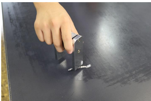
金属に磁石を近づけて鉄かどうか同定
