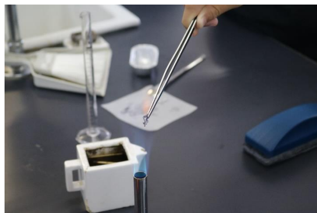
金属を加熱してマグネシウムかどうか同定
